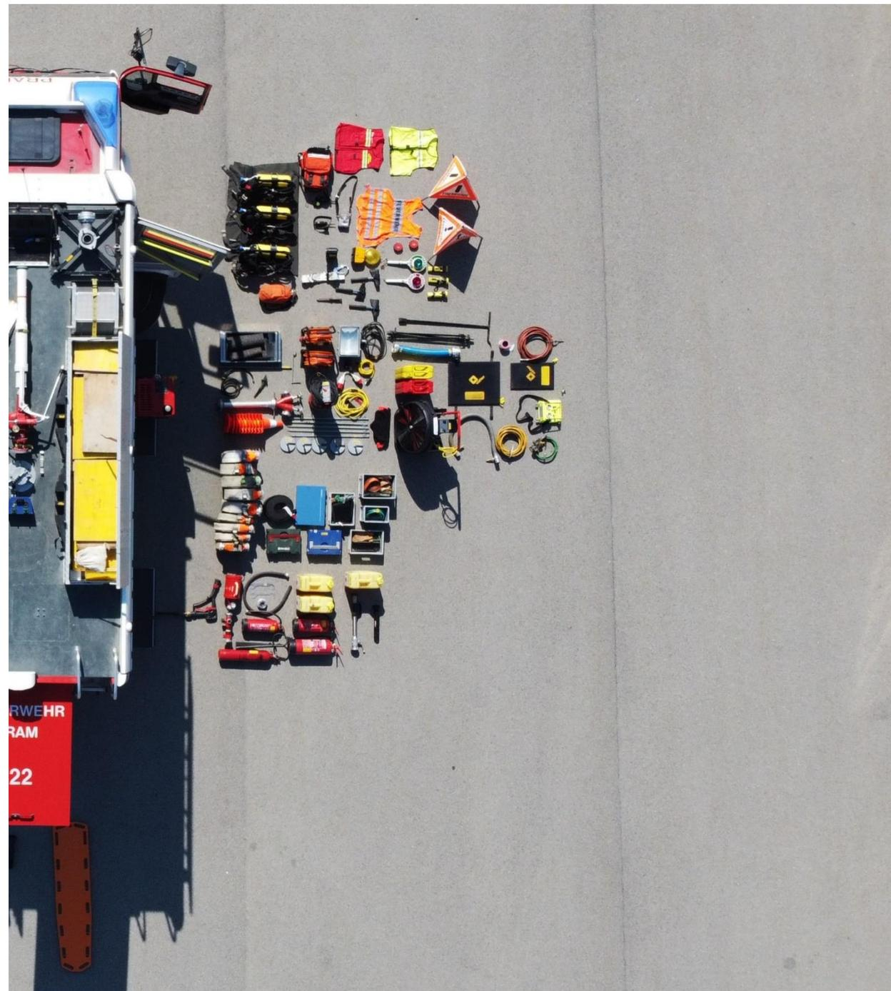
Für die Beförderung des Wassers zum Brandherd stehen ca. 600 m Schlauchmaterial zur Verfügung. Ebenfalls mit an Bord sind drei Atemschutzgeräte, welche die Einsatzkräfte bei Innenangriffen vor Atemgiften schützen. Weiters befinden sich im Fahrzeug noch 60 Liter Schaummittel und ein Lüfter, womit Innenräume rauchfrei gemacht werden können. Natürlich werden auch diverse Feuerlöscher für kleine Entstehungsbrände mitgeführt.
